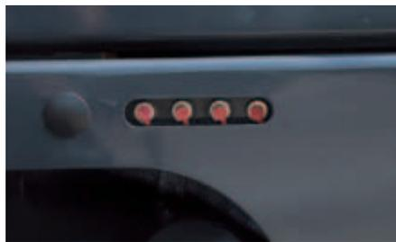
**Schmierstellen:** Zentralisierte Schmierstellen für Schwenkbock und Zylinder.
