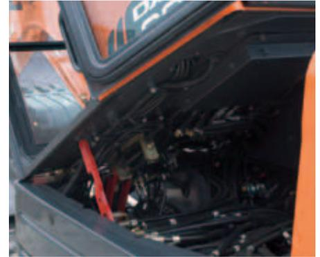
**Kippbare Kabine:** einfacher Zugang bei Wartungsarbeiten.
