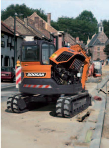
**Einfache Wartung:** Bequemer, seitlicher Zugriff auf die Motorkomponenten.
