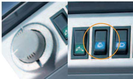
**Drehzahlverstellung / Automatische Leerlauffunktion:** Mittels der elektronischen Drehzahlregelung wird der Motor immer im optimalen Drehzahlbereich betrieben. Die serienmäßig installierte Leerlauffunktion führt zur Kraftstoffersparnis.
