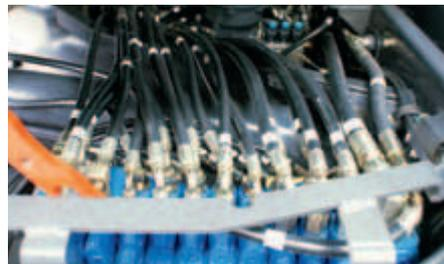
**Haupthydraulikventil:** Die Bewegungen der Maschine können einzeln oder simultan sehr feinfühlig gesteuert werden. Die optimale Abstimmung der Hydraulikfunktionen untereinander und ein Sperrventil im Hubzylinderkreis unterstützen den Fahrer im schwersten Einsatz.
